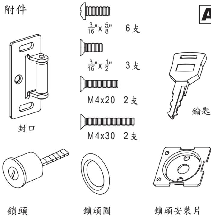
**A** 標定鎖頭及鎖身螺絲孔的位置尺寸然後開孔，將安裝尺卡緊貼門上挖室外門外表孔。
