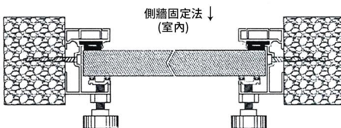
D. 邊柱材質： 不鏽鋼折板  鋁合金
